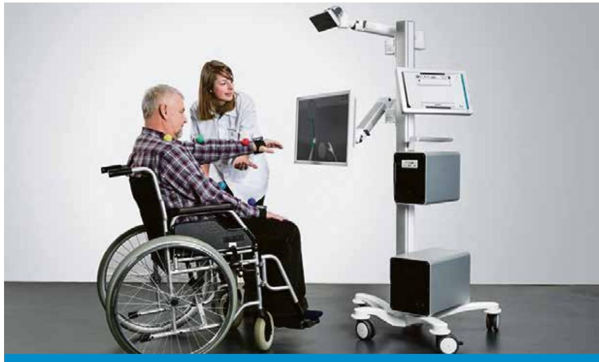
Des capteurs placés sur le corps du patient permettent d'enregistrer les mouvements et de les retranscrire sur un écran. Mindmaze
